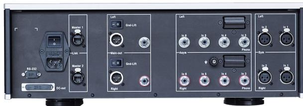
725的背板也很簡單，上下二排XLR與RCA端子很整齊，間隔也很大，方便蟒蛇級線材使用。另外有二個Link插槽，那是跟同廠器材連動使用的。
