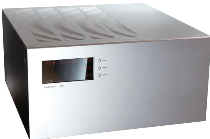
以 Soulution 过往的传统，既然要具备强大的输出能力，那么电源供应的规模肯定是相当可观的，毕竟 701 在单声道状态下输出功率高达 600W (8Ω)，因此每部 701 都内置了 4 组 600W 的音频级 Switched Mode 交互式电源，再结合高达 1000000 μF 的电容滤波，电源供应够强悍了吧。因此 701 在面对负载阻抗变化时能提供线性功率输出，在阻抗为 4 欧姆是输出倍增至 1200W，而最大的瞬间功率可达惊人的 12000W，面对任何复杂的音乐都有举重若轻的能力。
