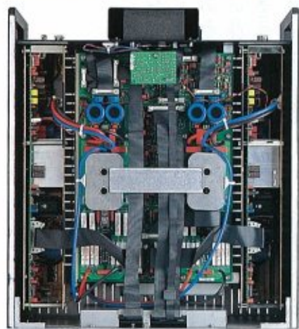
ステレオパワーアンプ710の天板を外して内部を見る。電源部を中央に、左右にアンプブロックを配置。電源回路の下にはスチールカバーで磁気シールドした1,000VAの容量を持つ電源トランスを左右独立で本体前後方向に搭載。出力段は14個のバイポーラトランジスターからなり、6mm厚の銅板を介してシャーシ下部に取り付けられている。
