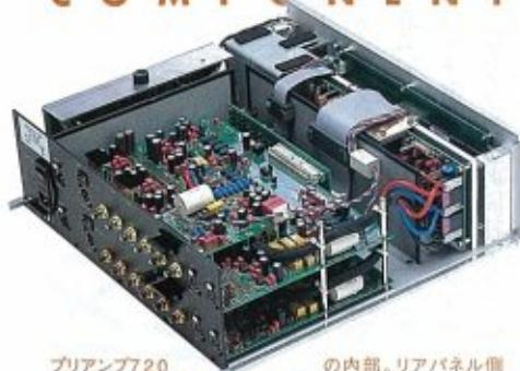
プリアンプ720 の内部。リアパネル側に配された増幅部 は左右独立し、上下2段のモジュラ構成。最上段に載っている小型の基板は、MC専用フォノイコライザーベース。入力はフォノ1系統を含むアンバランス4系統とバランス2系統。出力はアンバランス、バランスそれぞれ1系統装備する。増幅部を取り囲むようにL字型に配置された電源部はシールド板を介して配置。コントロール系と増幅系は電気的にも物理的にも完全に分離されており、アンプ回路用の電源はリニア電源回路、デジタル・コントロール回路用はスイッチング電源回路という組合せである。
