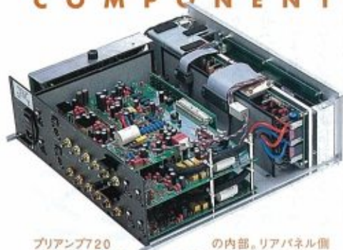
プリアンプ720の内部。リアパネル側に配された増幅部は左右独立し、上下2段のモノラル構成。最上段に載っている小型の基板は、MC専用フォノコライザー基板。入力はフォノ1系統を含むアンバランス4系統とバランス2系統。出力はアンバランス、バランスをそれぞれ1系統装備する。増幅部を取り囲むようにL字型に配置された電源部はシールド板を介して配置。コントロール系と増幅系は電気的にも物理的にも完全に分離されており、アンプ回路用の電源はリニア電源回路、デジタル・コントロール回路用はスイッチング電源回路という組合せである。
