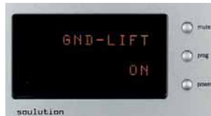
Mit Ground-Lift können eventuelle Erdschleifen getrennt und Brumm vermieden werden
