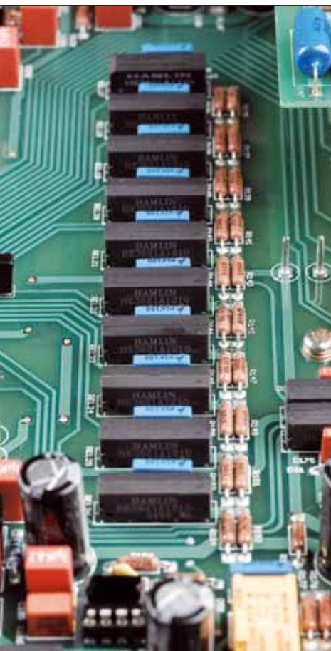
Diese Relais bilden einen Kanal des „richtigen“ Lautstärkestellers, der beim Verstellen von einer elektronischen Lösung überbrückt wird
