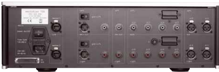
Standesgemäß: die unsymmetrischen Anschlüsse sind mit WBT-Nextgen-Buchsen realisiert
