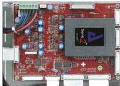
Vor der Wandlung durchläuft das Signal diesen Sample Rate Converter
