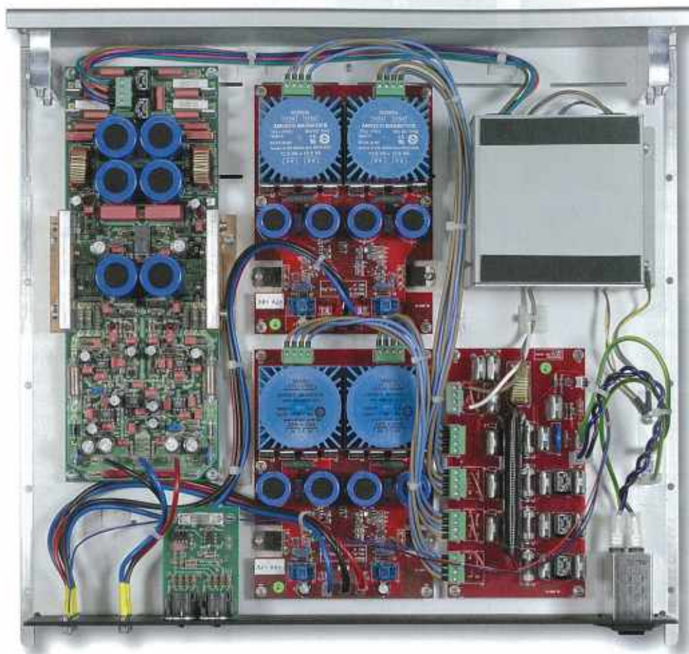
Drei separate Netzteile versorgen die analogen Baugruppen, die digitale Signalaufbereitung und das Laufwerk. Die Stromversorgung der Analogstufen entspricht derjenigen der Vorstufe 720
