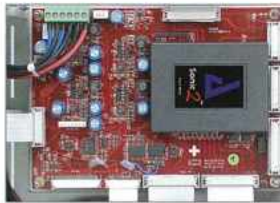
Vor der Wandlung durchläuft das Signal diesen Sample Rate Converter
