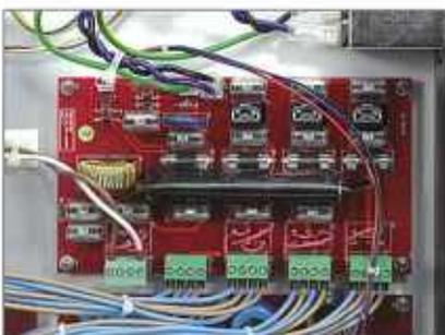
Hier wird der Netzstrom gefiltert, bevor er zu den Trafos gelangt
