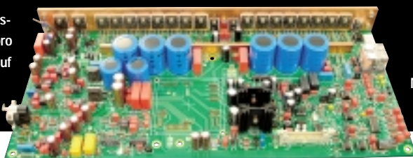
Aluplatten schützen einige der Kondensatoren auf der Netzteilplatine vor Schwingungen
