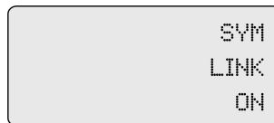
Display im Betriebszustand ON, Mode NORM
