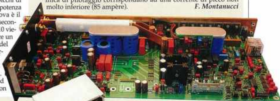
Una delle piastre corrispondenti ad un canale private delle coperture laterali in rame, con il modulo di prima amplificazione rimosso dallo stampato.
