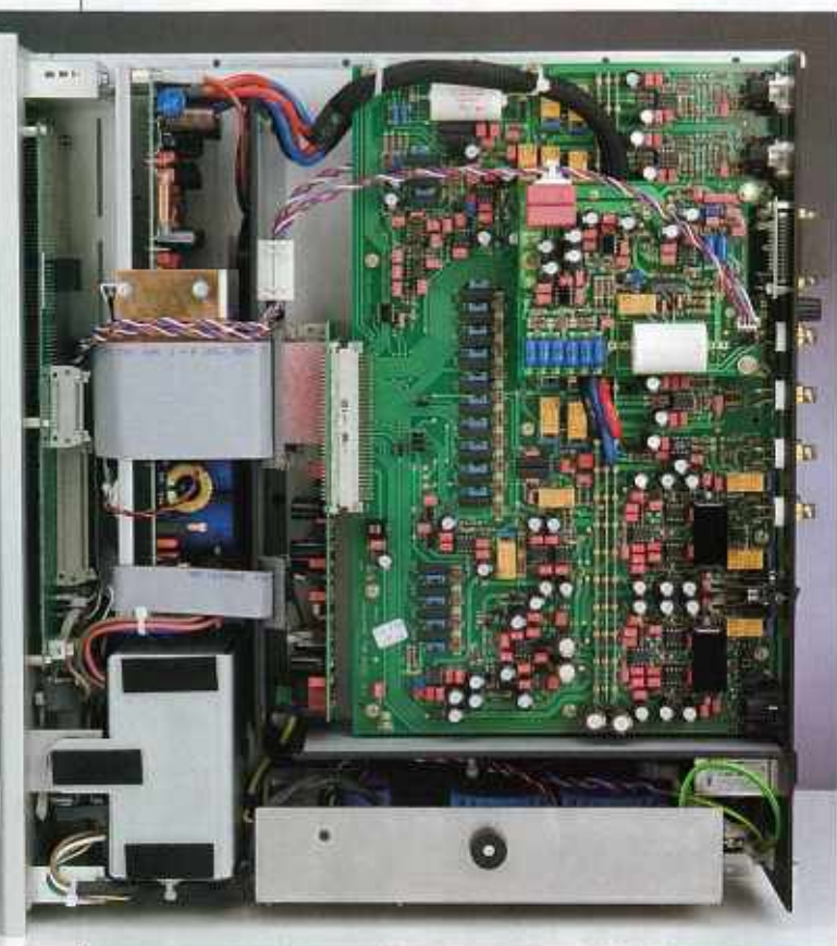
L'interno del Souldution 710 è una sorta di "nana bianca" dell'hi-fi, tanto densa è la componentistica. Da notare l'assenza di dissipatori convenzionali, sostituiti in parte dalle pareti di rame che racchiudono i circuiti di amplificazione e soprattutto dall'intero telaio, che è in larga misura in alluminio pieno ed anodizzato da 12 mm. Esiste anche una ventola centrale, silenziata da una copertura in gommapiuma e destinata ad aerare il settore centrale, ma nel corso dell'utilizzo non siamo mai riusciti a percepirla l'attivazione.
