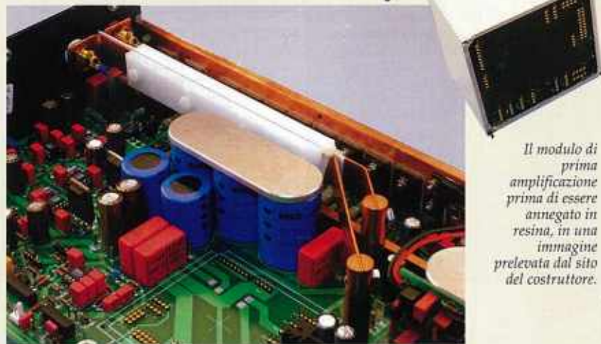
Una delle piastre corrispondenti ad un canale private delle coperture laterali in rame, con il modulo di prima amplificazione rimosso dallo stampato.
