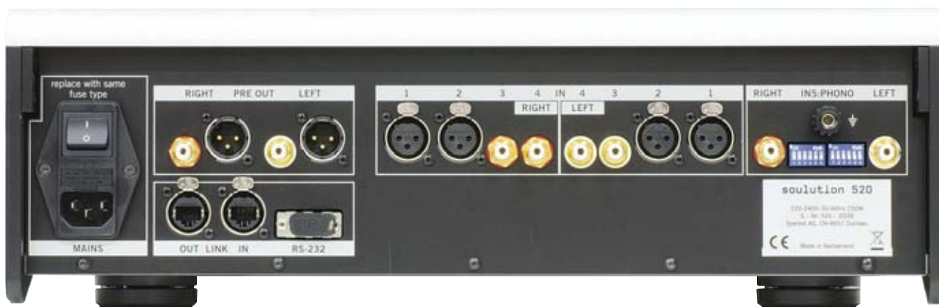
Le connessioni sul pannello posteriore sono distribuite in corrispondenza delle varie sezioni circuitali presenti all'interno del cabinet. Partendo da destra troviamo l'ingresso fono, con i microswitch per la regolazione dell'impedenza, a seguire gli ingressi linea, due bilanciati e le uscite.
