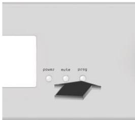
Mit der Prog-Taste wechseln Sie in den Programm-Modus. Der Programm-Modus wird durch erneuten Druck oder Timeout von 10 Sekunden wieder verlassen.
