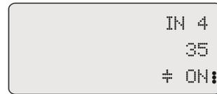
Display im Betriebszustand ON, Schutzkondensator aktiv
